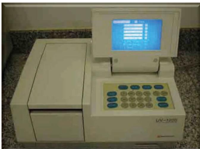
Figura 4 :Espectrofotômetro utilizado para leitura do filtrado.
