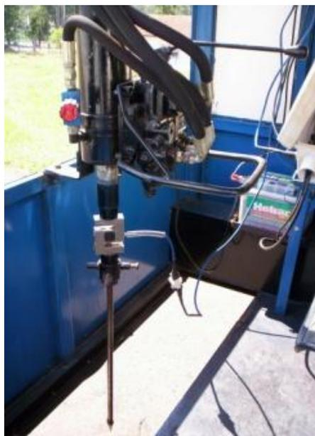
Figura 7. Penetrômetro hidráulico-eletrônico instalado na UMAS – Unidade Móvel de Amostragem do Solo.
