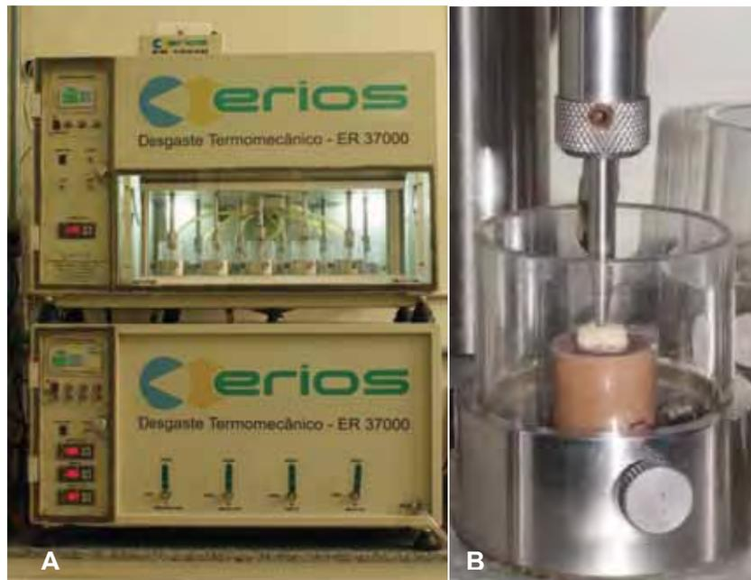
Figura 5 – A) Máquina de Desgaste Termomecânico; B) Espécime posicionado na máquina.
