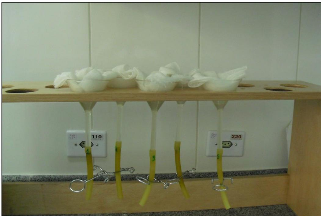
**Figura 6.** Aparelho de Baermann utilizado para a coleta de larvas de nematóides.
