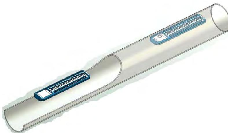
Figura 2. Modelo de mangueira gotejadora com emissor gotejador plano.
