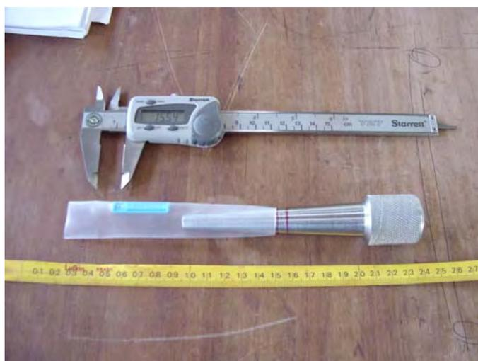
Figura 9. Ferramenta cônica e paquímetro para avaliar diâmetro interno.
