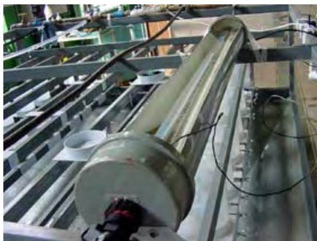
Figura 10. Recipiente com resistência elétrica para aquecimento.
