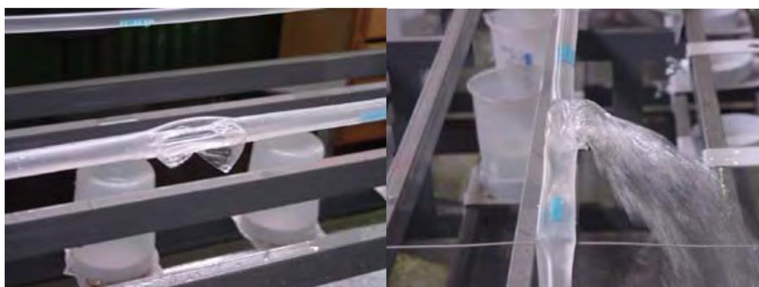
Figura 12. Vesícula rompida antes da pressão atingir 216 kPa, no protótipo P2015.
