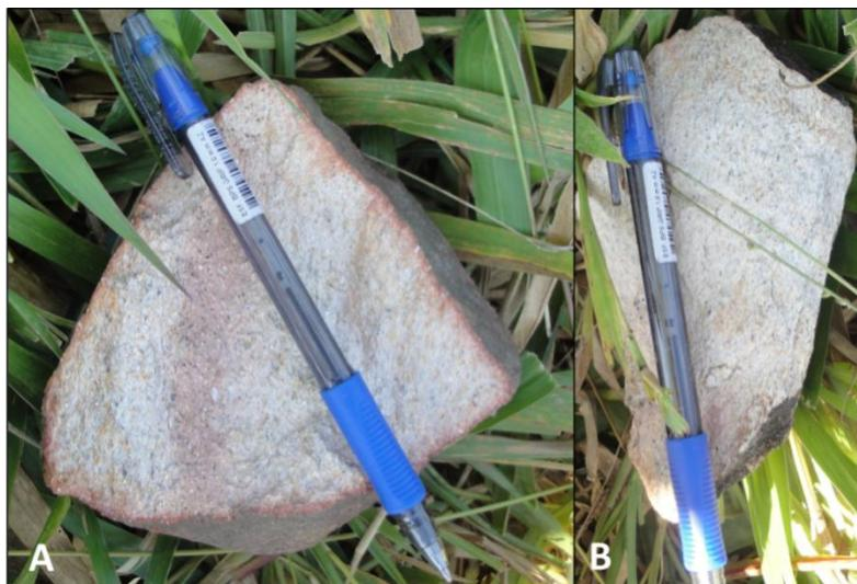
Figura 4: em A e B amostras da rocha encaixante representada por quartzo mica xisto de cor creme, com foliação bem marcada.
