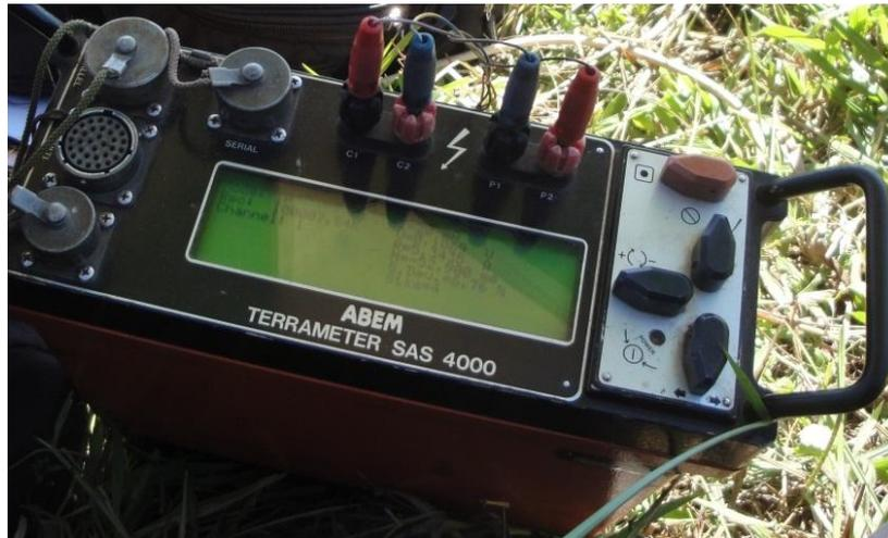
Figura 12: Resistivímetro Terrameter SAS 4000 efetuando medidas em campo.
