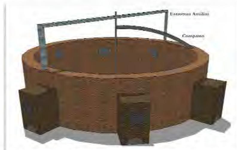
Figura 44: Esquema do molde para execução da abóboda. Fonte: Autor.
