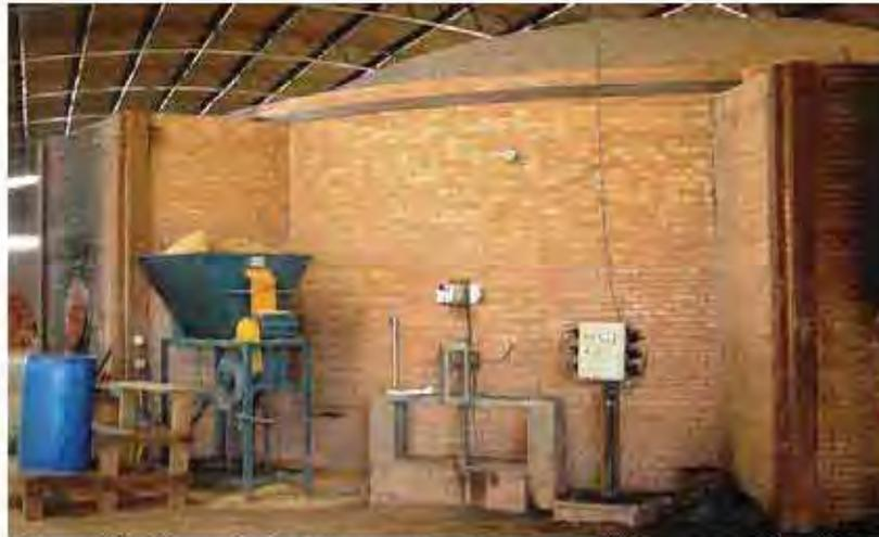
**Figura 24: Forno abóboda com maquina para pó de serra na fornalha.**
