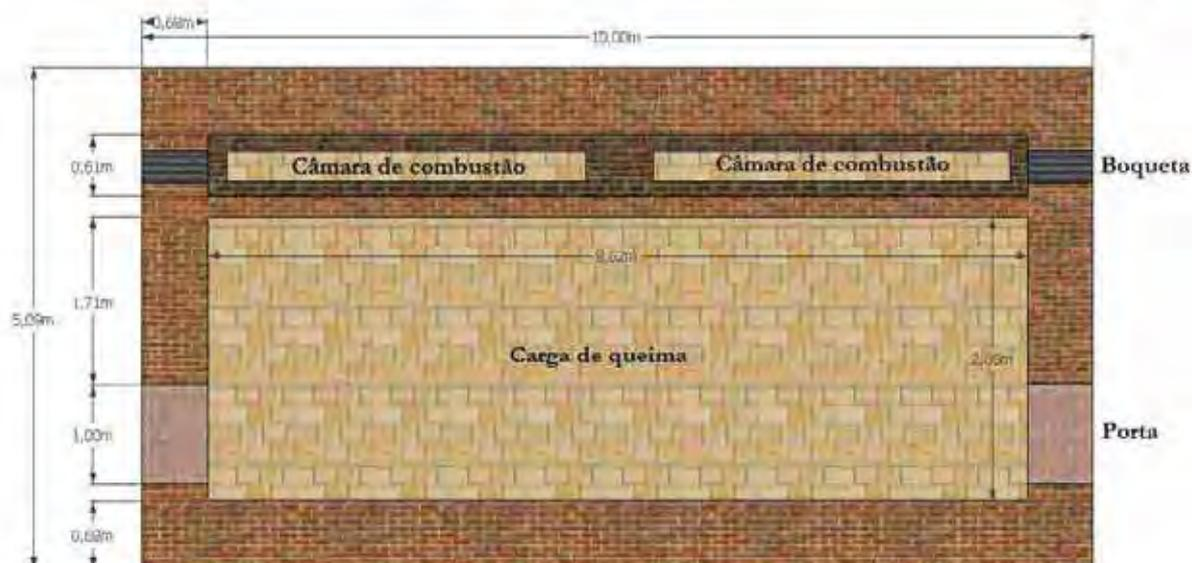
**Figura 65: Representação da planta baixa do novo modelo de forno. Fonte: Autor.**
