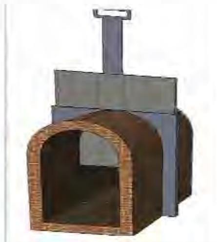
**Figura 34: Esquema de registro em canal de ar.**
