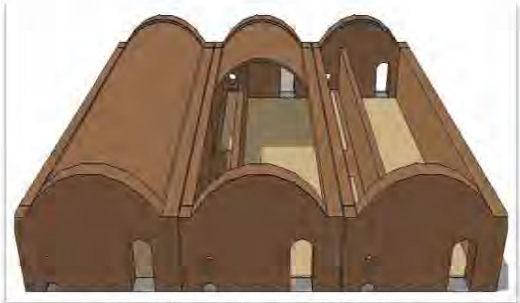
**Figura 63: Construção de fornos um ao lado do outro.**
