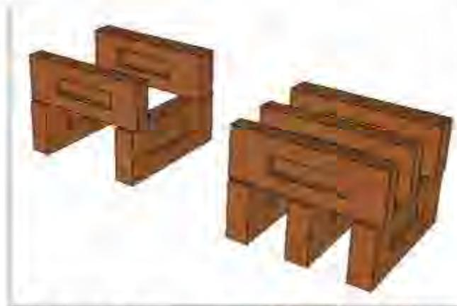
**Figura 48 B: Paginação da arrumação dos tijolos dois por dois e três por três.**
