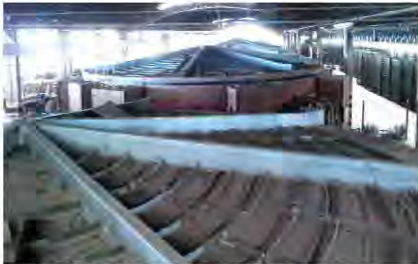
Figura 37: Fornos com abóboda de manta térmica. Fonte: Autor.
