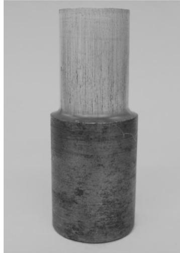
Figura 3.10 - Conjunto formado pela base e corpo de prova.
