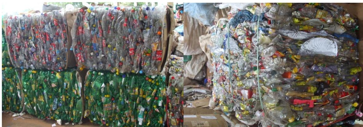
Figura 48 - Pet transparente e Pet verde prensados
