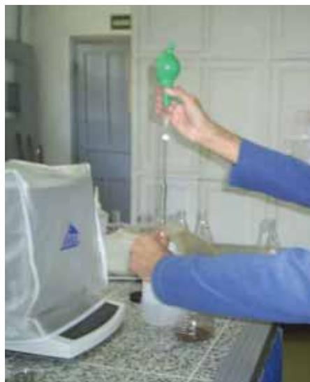
Figura 10: Preparação das amostras para o processo de agitação que separa a areia, o silte e a argila.
