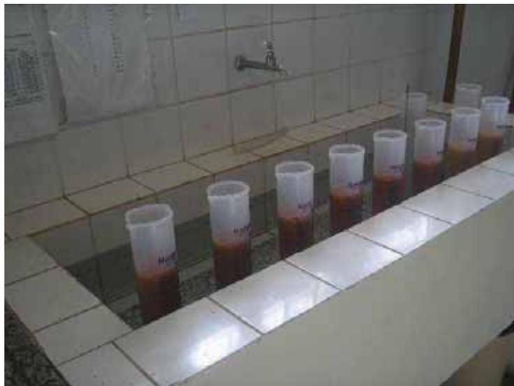
Figura 11: Provetas com a argila e o silte em processo de decantação.
