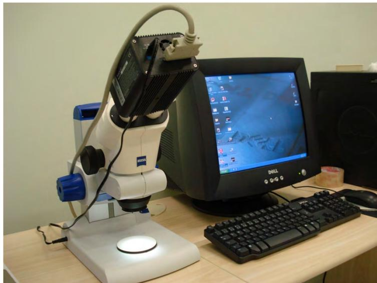
Figura 3.15 – Estereomicroscópio da Zeiss Stemi 2000.
