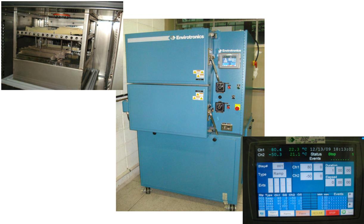
Figura 3.6 – Câmara de choque térmico utilizada no condicionamento por variação cíclica de temperatura, da Envirotronics, modelo TSV.5-2-2-2-AC-X.
