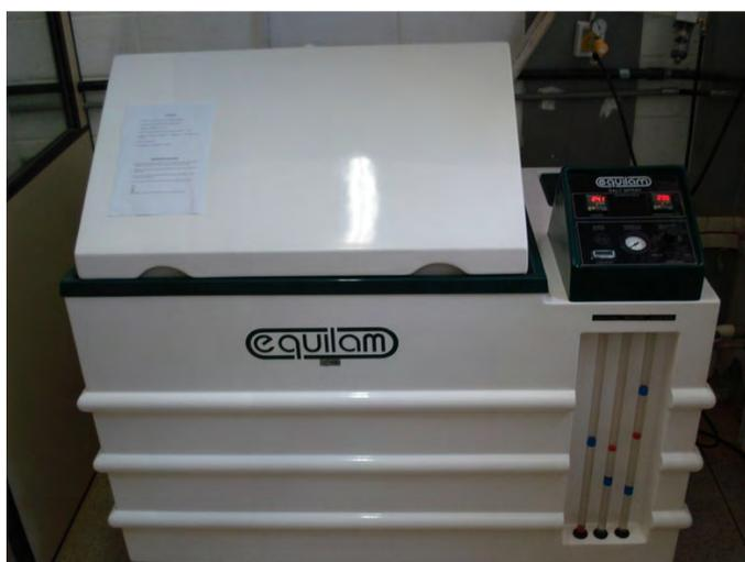
Figura 3.5 – Câmara de atmosfera salina da Equilam, modelo SS600e.
