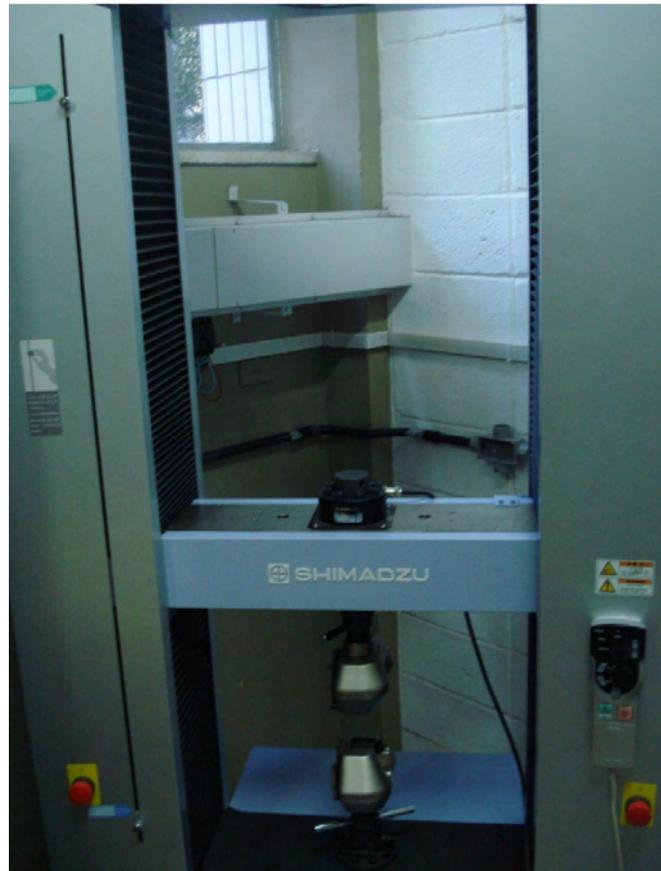
Figura 3.9 – Máquina universal de ensaios da Shimadzu AG-X.
