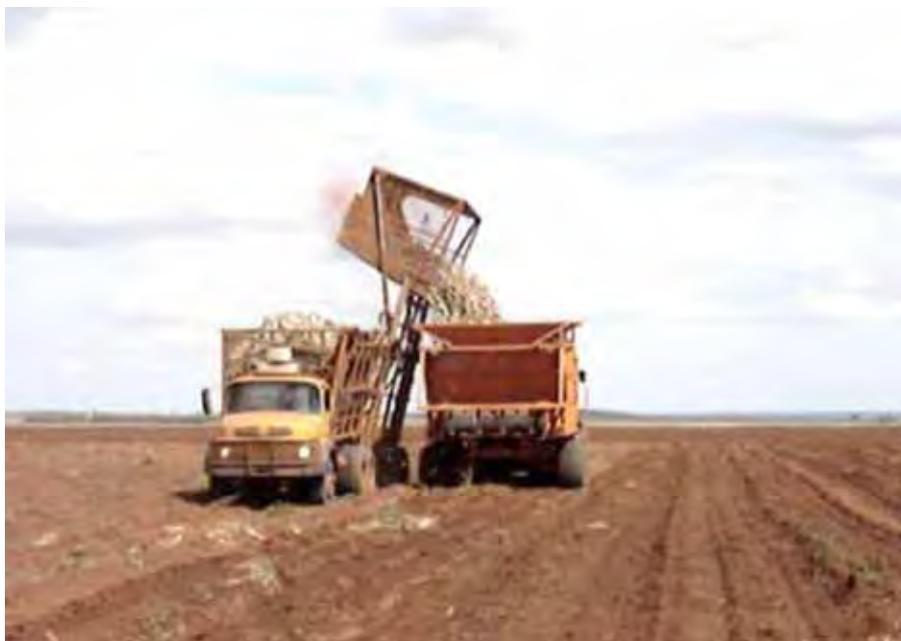
**Figura 14.** Plantio mecanizado (transbordo abastecendo a plantadeira)
