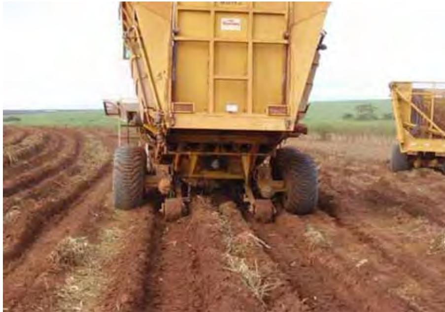
**Figura 15.** Plantadora (cobrindo sulcos de plantio)
