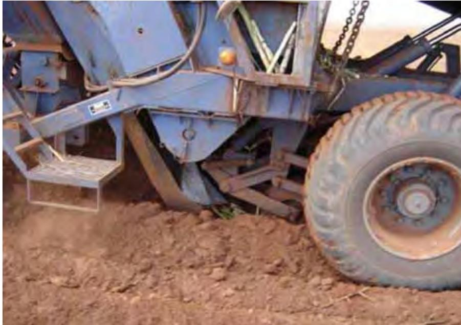
**Figura 13.** Plantadora (realizando sulcação, adubação, distribuição da muda, aplicação do defensivo e cobertura do sulco)
