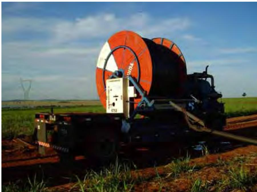
**Figura 32.** Aparelho de irrigação (auto propellido - aplicação de vinhaça)
