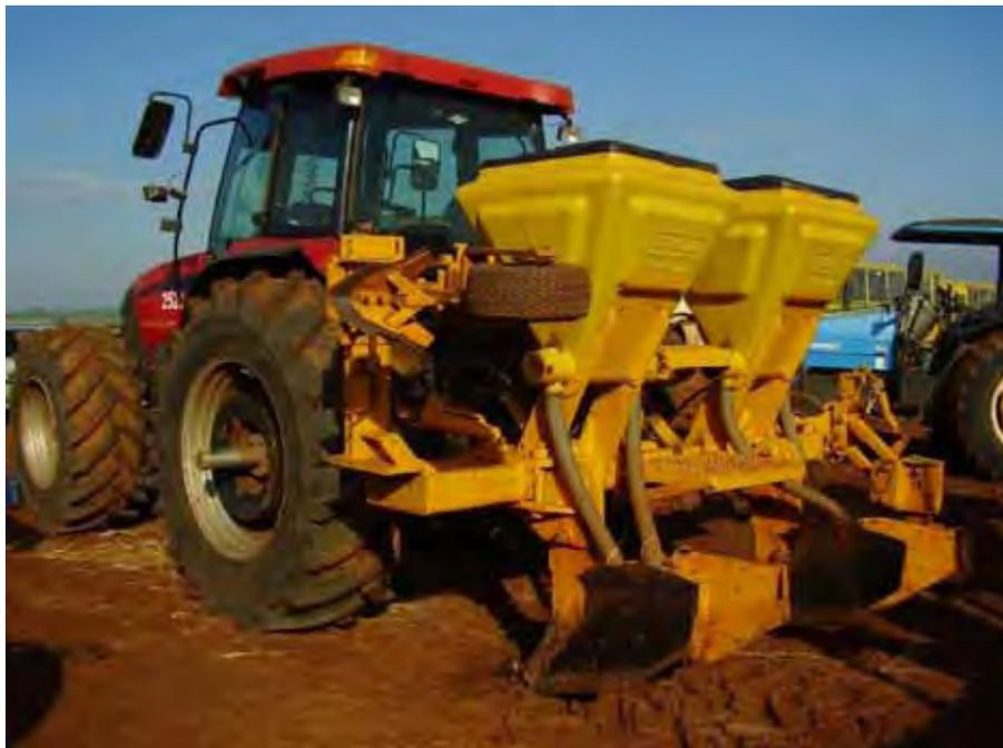
Figura 6. Trator acoplado ao sulcador e adubador
