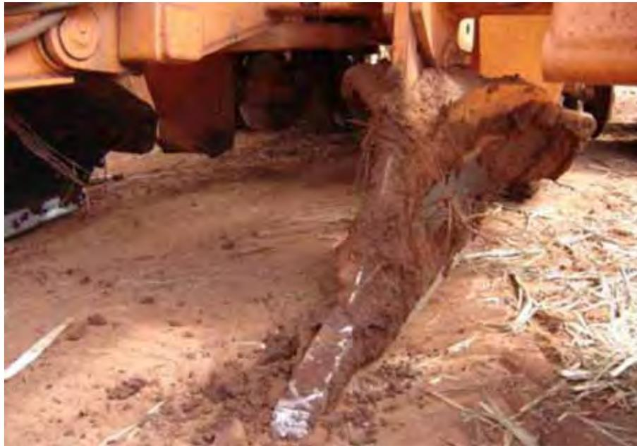
**Figura 11.** Plantio mecanizado (sulcador da plantadora)
