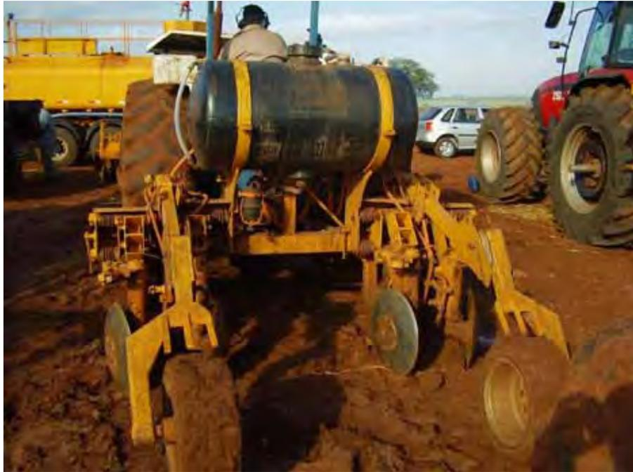
**Figura 7.** Trator acoplado ao aplicador de defensivos e cobridor
