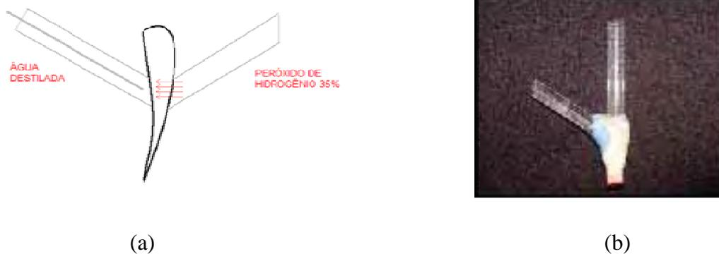
Figura 2. (a) Desenho esquemático do setup experimental; (b) Aspecto dos capilares adaptados no dente com resina acrílica.
