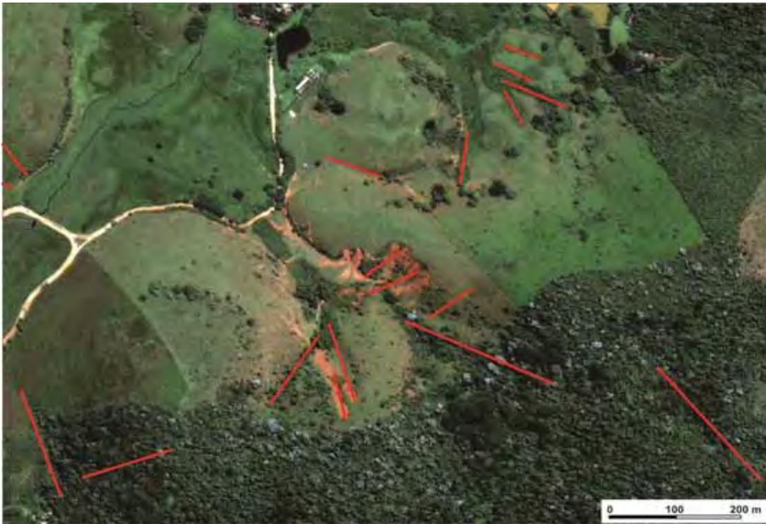
**Figura 6.3.** Fraturas (traços em vermelho) extraídas na imagem GeoEye de janeiro/2010.
