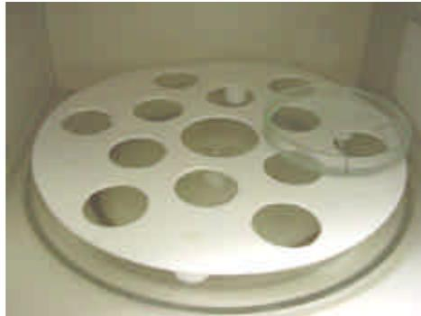
Figura 5 – Corpos-de-prova no interior do forno de microondas
