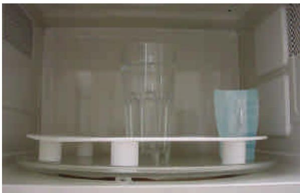
FIGURA 7 – Corpo-de-prova no interior do forno de microondas
