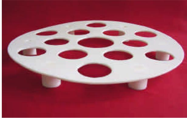
FIGURA 3 – Suporte para os corpos-de-prova
