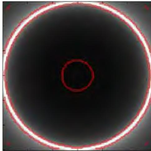
Figura 24: Reconstrução da imagem para um feixe monoenergético de prótons de 200 MeV sem considerar partículas secundárias em graus de cinza.
