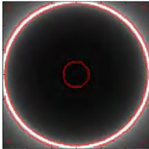
Figura 22: Reconstrução da imagem para um feixe monoenergético de prótons de 200 MeV considerando partículas secundárias em graus de cinza.
