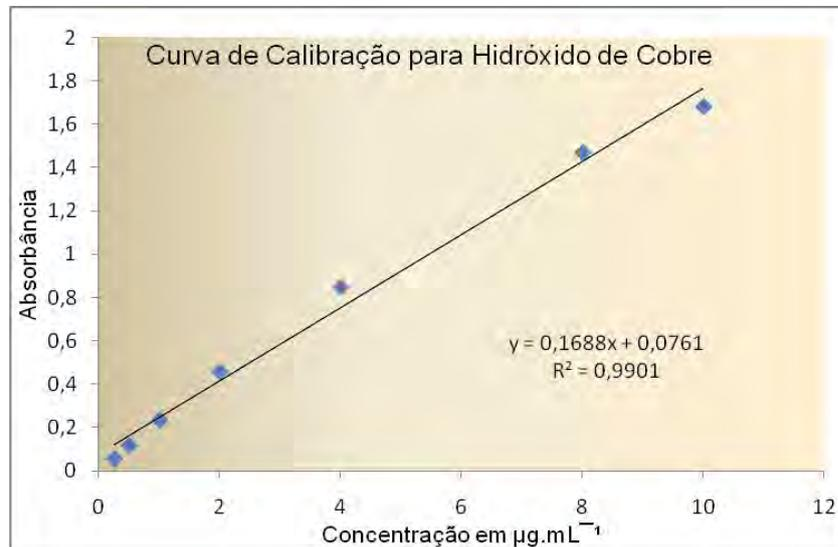
Figura 6. Curva de calibração com as soluções com concentrações crescentes de hidróxido de cobre.
