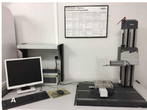
**Figura 8-** Perfilômetro de contato Mahr-Goettingen
