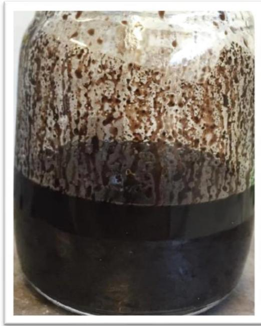
**Figura 6.** Início da separação de fases após adição de ácido sulfúrico.
