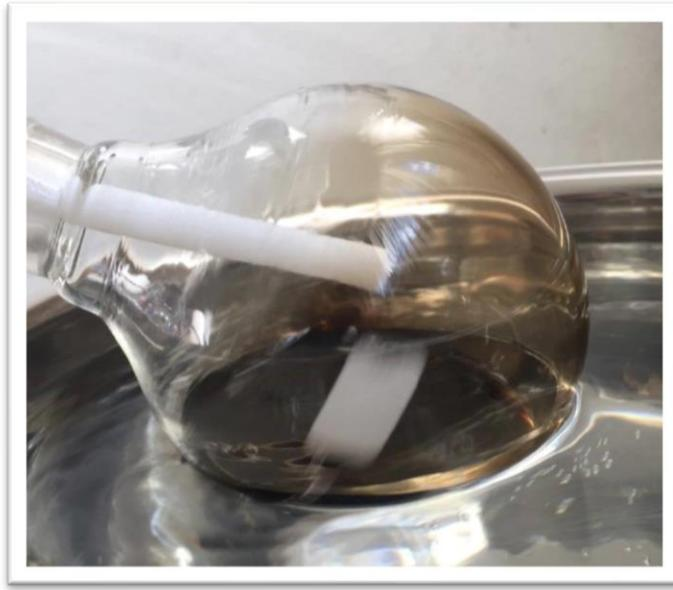
**Figura 10.** Redução da amostra por Rotaevaporador em banho maria.
