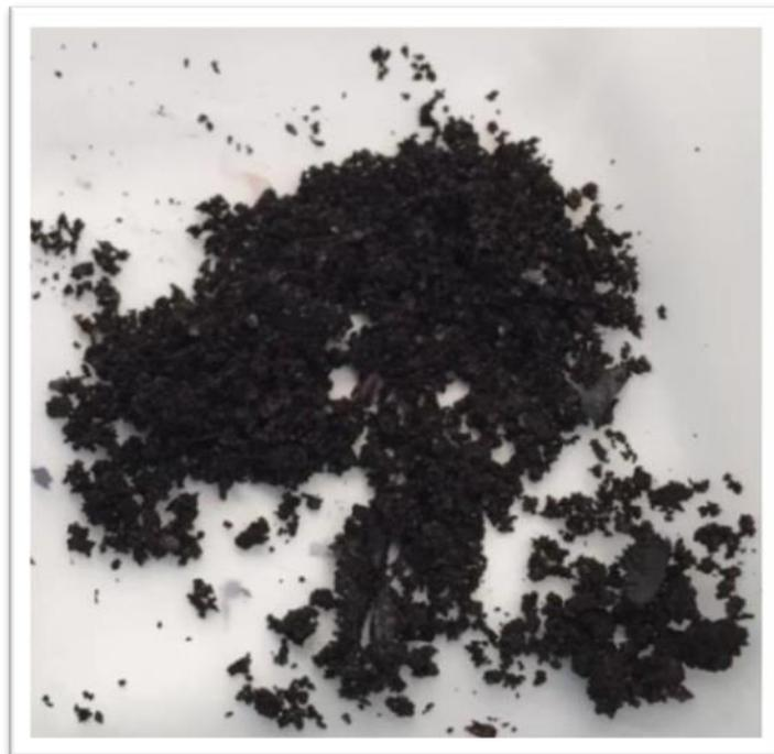
**Figura 11.** Lignocresol após secagem em estufa.
