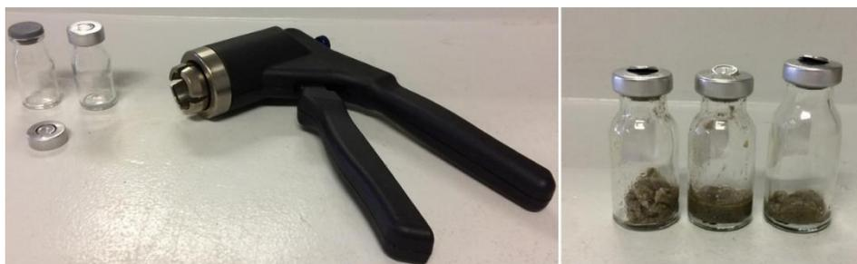
Figura 54: Frascos de 20mL utilizados nos ensaios de cromatografia gasosa acoplada à espectrometria de massas (CG/MS), com amostras de sedimentos contaminadas. Fonte: Roberta Merguizo Chinellato.
