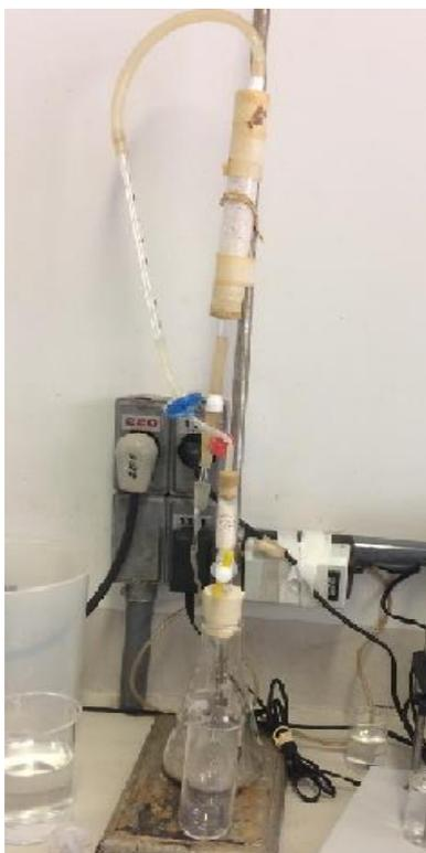
Figura 29: Sistema de renovação do ar através da utilização de um compressor de ar e um filtro de cal sodada (Vetec PA). Fonte: Roberta Merguizo Chinellato.
