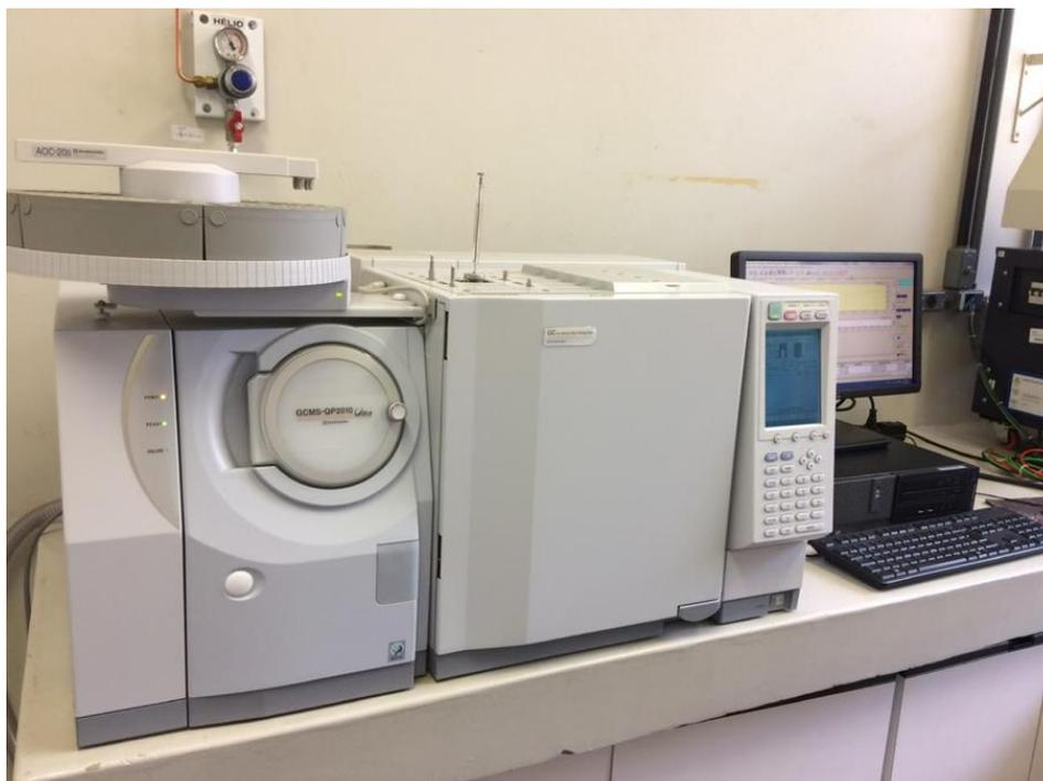
*Figura 56: Equipamento GC/MS Shimadzu QP2010 ULTRA, com espectrômetro de massas com detector com fonte ionizada (EI -70 eV) e analisador de massas quadrupolo. Fonte: Roberta Merguizo Chinellato.*
