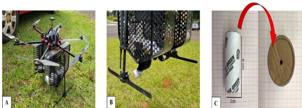
Figura 1. Aeronave X800 GEO hexacóptero (A) utilizada para liberar pupas de *Diatraea saccharalis* (Lepidoptera: Crambidae) parasitadas por *Trichospilus diatraeae* (Hymenoptera: Eulophidae) com implemento tipo cesto, cápsula para liberação de pupas parasitadas (B) e teste da aeronave e dispositivo antes da liberação (C). Botucatu, São Paulo, Brasil.
