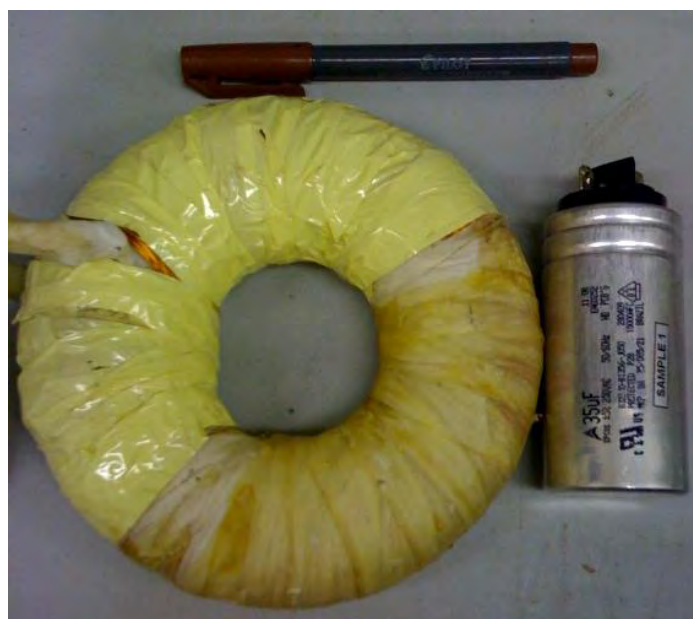
Figura C.12 – Indutor de filtro – 1,3mH/33A e capacitor de filtro – 35 \mu F/250VAC.
