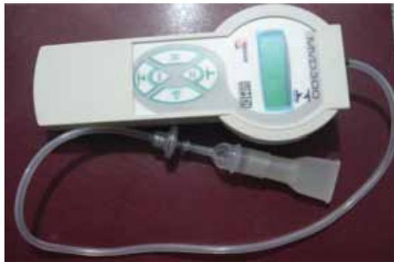
**FIGURA 2.** Ilustração do manovacuômetro MVD300.
