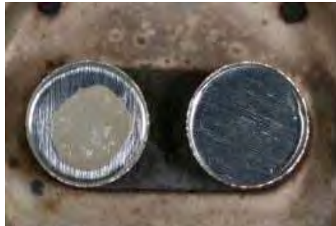
Figura 4 - Painel com resina no termopar esquerdo, e painel vazia no termopar direito.
