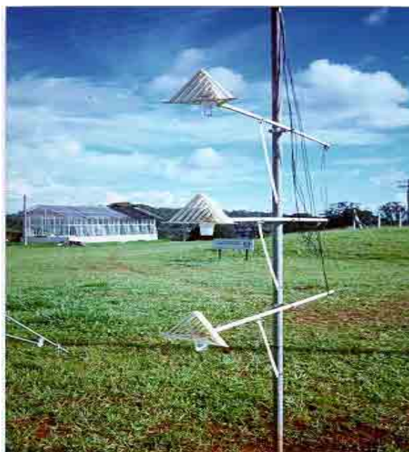
Figura 4: Conjunto de micro-abrigos instalados na área de teste.
