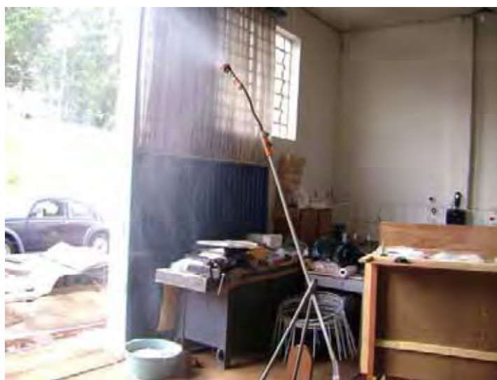
Figura 17: Ponta de pulverização utilizada para umidificar o ar do laboratório.
