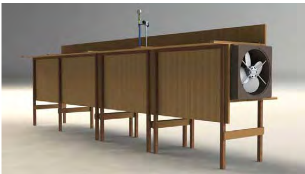
Figura 23: Desenho do túnel de vento com destaque para o posicionamento do motor.
