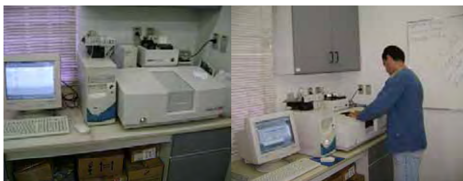
Figura 29: Espectrofotômetro UV-visível utilizado nas medidas de absorbância.
