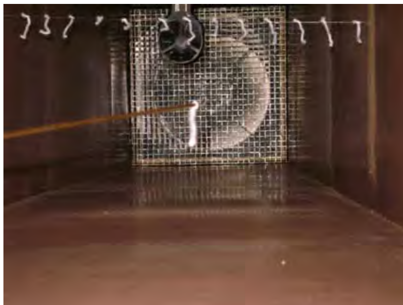
Figura 13: Haste e “varal” de fios de lã utilizados nos ensaios de visualização.
