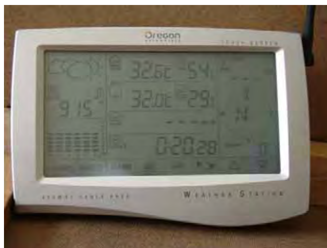
Figura 12- Estação de medida de temperatura e umidade relativa do ar usados nos ensaios.
