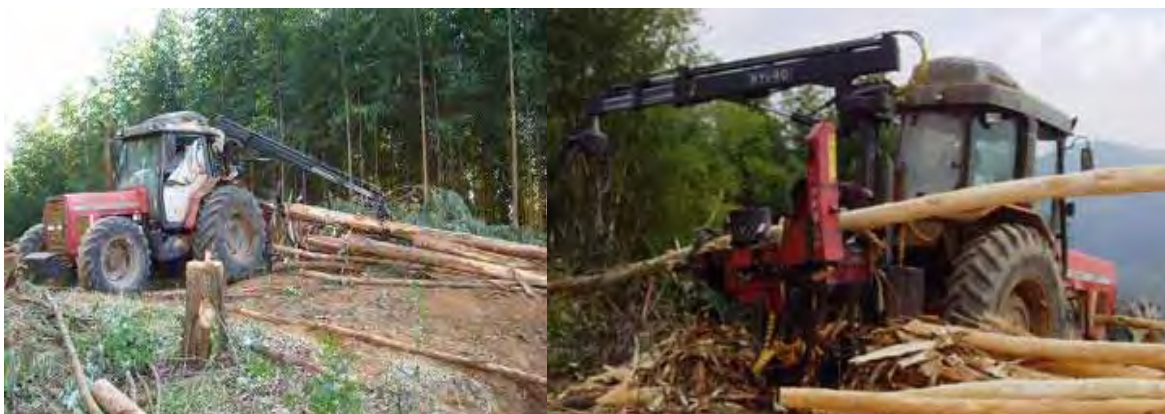
Figura 25. Operador acionando a grua e garra conduzindo tora para plataforma de processamento
