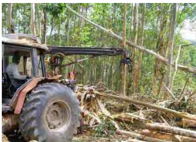
Figura 19. Trator MF 297 com cabine modificada e processador HYPRO AB 650-4WD.
