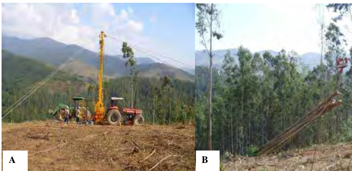
Figura 16. Trator Massey Ferguson 297 com conjunto teleférico Penzsaur/Koller K301T acoplado e trator John Deere utilizado para arraste (A) e extração com carrinho transportador (B).
