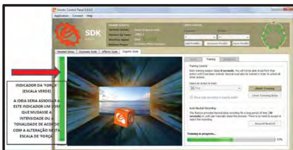
FIGURA 98 – Software Control Panel, na função Cognitiv Suite. Observe a escala na cor verde do lado esquerdo, que proporciona feedback visual sobre a intensidade do treinamento cognitivo.
