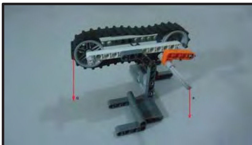
FIGURA 29 - Sarilho, com indicação da força Potente P, e do peso resistente Q.
