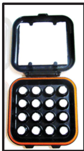
FIGURA 99 – Sensores de feltro utilizado nos sensores do head-set da interface Emotiv Eloc. Aqui, estão acondicionados em estojo para armazenamento e transporte.
