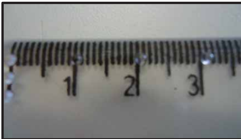
FIGURA 43 - Régua e esquadro com marcação em alto relevo de centímetro em centímetro. A origem é marcada com três pontos.
