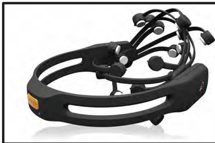
FIGURA 14 - Headset da Interface cérebro-computador Emotiv Epoc®
