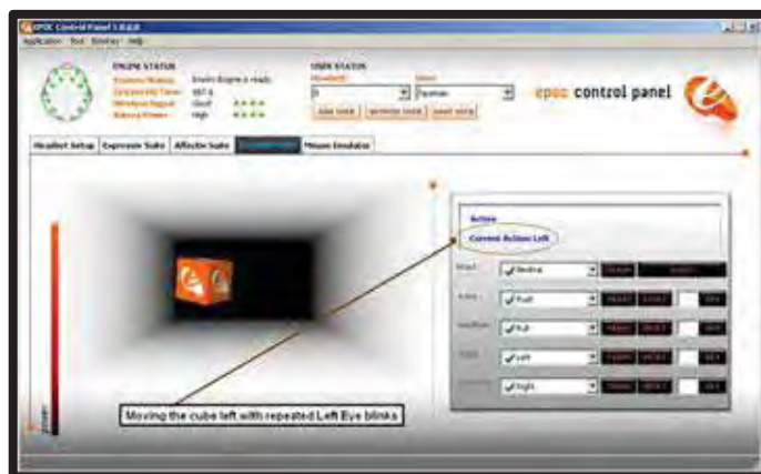
FIGURA 53 - Painel de Controle do software da ICC Emotiv Epoc, mostrando no detalhe a configuração dos respectivos lados treinados para a movimentação do cubo virtual.
