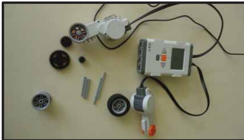
FIGURA 48 - Unidade de processamento central do kit de robótica LEGO MINDSTORMS, conectado a dois servomotores, além de rodas, pneus, engrenagens e eixos.
