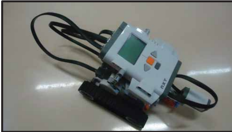
FIGURA 31 – Montagem do robô (jipe) controlado através da interface cérebro-computador.
