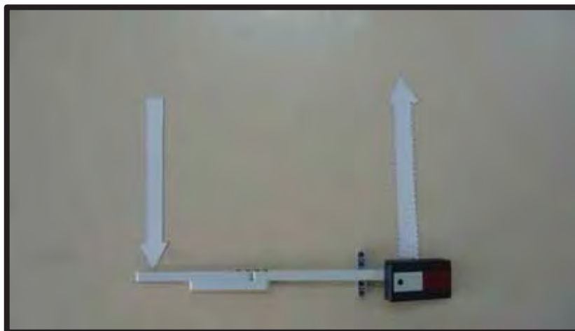
FIGURA 87 - Representação das Forças Potente e Resistente numa alavanca utilizando flechas lisa (esquerda) e serrilhada (direita). A alavanca (as três barras na horizontal) e o ponto de apoio (barra na vertical) foi construída com material do kit LEGO Mindstorms NXT 2.0.
