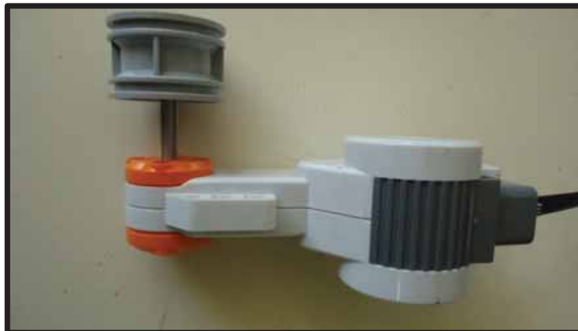
FIGURA 49 - Servomotor conectado com uma roda através de um eixo.
