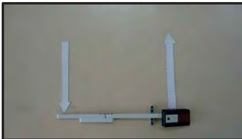
Figura 62 – Flechas lisa (esquerda) representando a força potente, e flecha serrilhada (direita) representando a força resistente.
