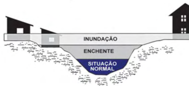
Figura 4.16 – Perfil esquemático dos processos de enchente e inundação. Fonte: Brasil (2007b).
