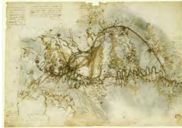
Figura 2.6 - O plano de desvio e canalização do rio Arno, Itália, de Leonardo da Vinci, é o primeiro projeto de alteração substancial de um sistema fluvial do início da Era Moderna (1502). Fonte: extraído de http://www.royalcollection.org.uk/
