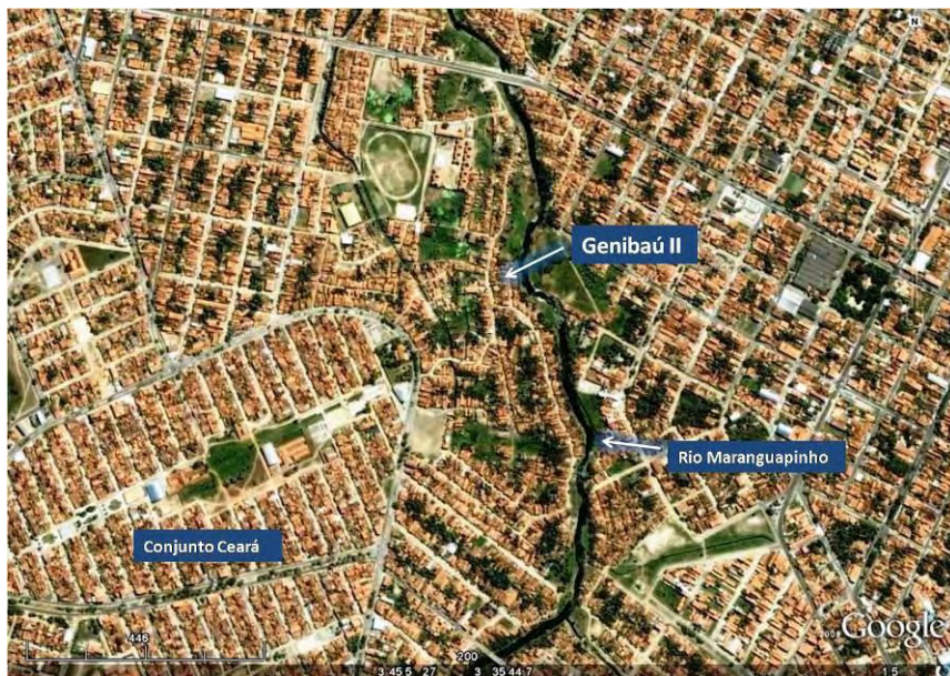
Figura 4.62 – Detalhe da comunidade Genibaú II. O sítio urbano dessa comunidade está estruturado em terrenos deprimidos e alagáveis, além de uma rede de drenagem densamente ramificada, canalizada e retinizada. Fonte: modificado de Google Earth, 2009.
