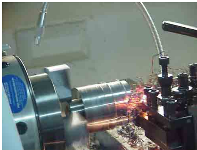
Figura 4.33 Observa-se cavacos aderidos na interface ferramenta-peça
