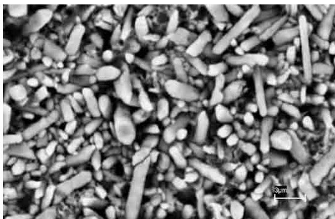
Figura 4.10 Observa-se uma microestrutura majoritária de \alpha - \text{SiAlON} - SNYA20
