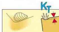
Figura 2.12 Desgaste de cratera de uma ferramenta de corte (SANDVIK, 2000).
