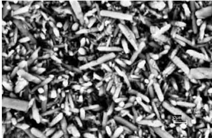
Figura 4.8 Observa-se uma microestrutura com presença de grãos \beta - \text{Si}_3\text{N}_4 -SNYAL10
