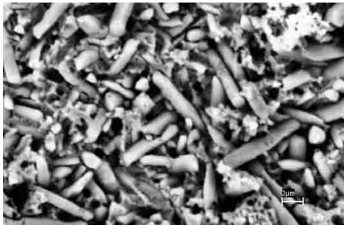
Figura 4.9 Observa-se uma microestrutura duplex grãos \alpha - \text{SiAlON}/\beta - \text{Si}_3\text{N}_4 - SNYA15
