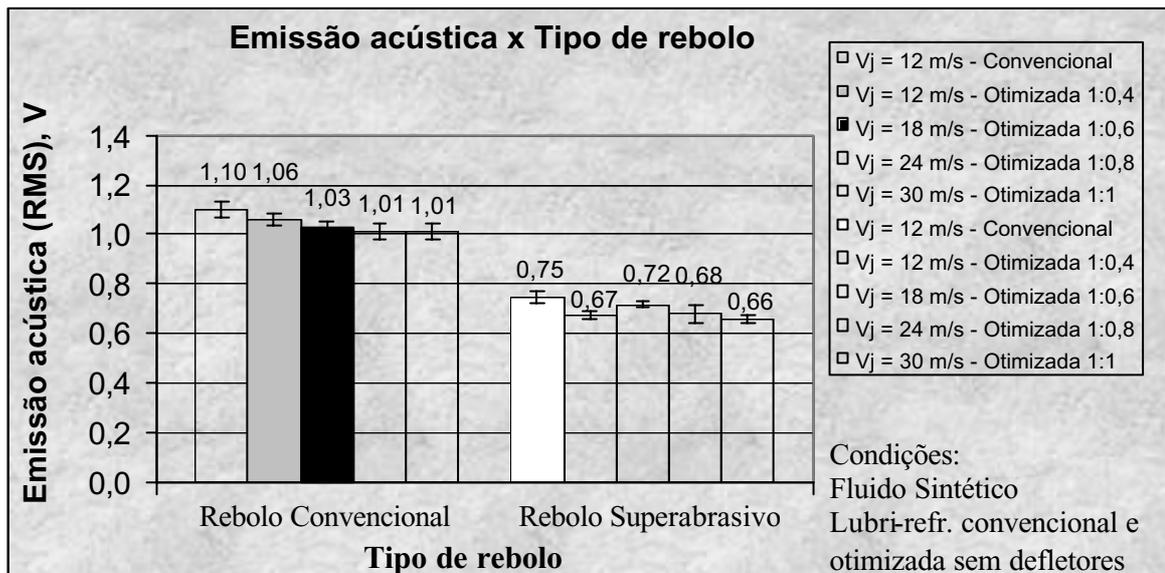
Figura 4.29 – Influência do tipo de rebolo na EA (RMS), empregando-se uma lubri-refrigeração convencional e uma otimizada sem defletores utilizando fluido sintético
