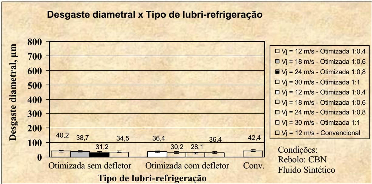
Figura 4.49 – Influência da velocidade de aplicação do fluido e tipo de lubri-refrigeração no desgaste diametral do rebolo mediante utilização do rebolo de CBN e fluido sintético
