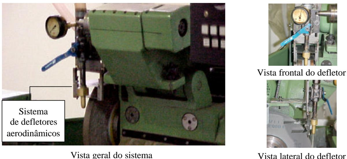
Figura 3.9 – Sistema de defletores fixo na retificadora cilíndrica
