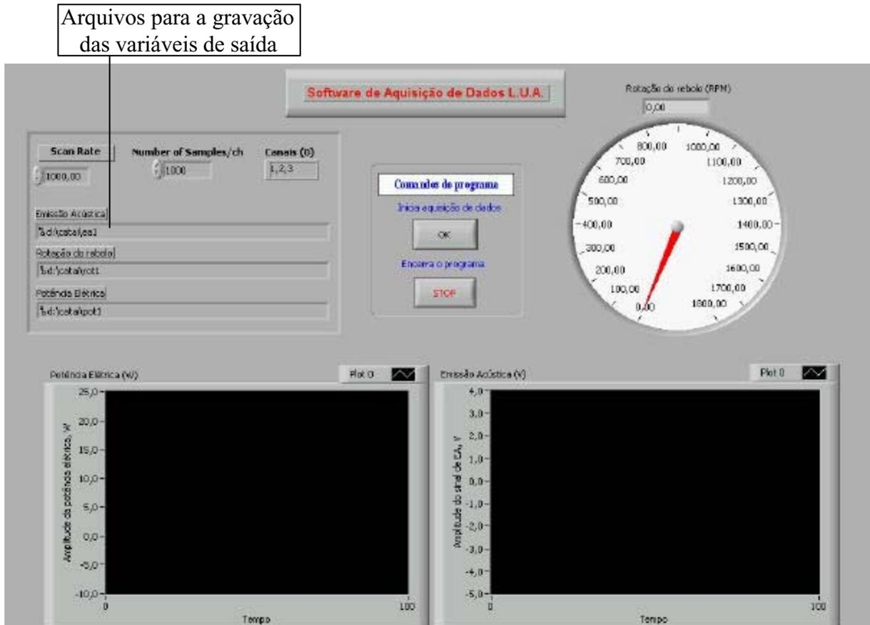
Figura 3.15 – Tela do programa de aquisição de dados para algumas das variáveis de saída obtidas diretamente durante o processo de retificação
