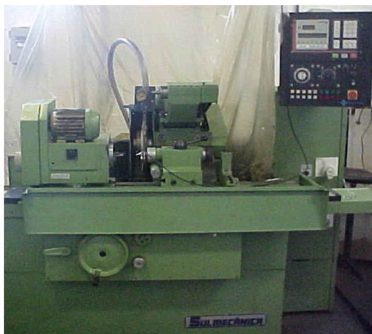
Figura 3.10 – Retificadora cilíndrica da marca SULMECÂNICA com CNC (Comando Numérico Computadorizado)
