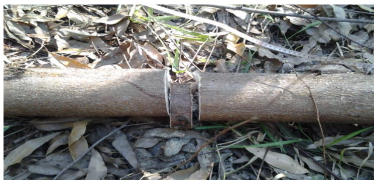
Figura 2- Forma de retirada dos discos para análise de densidade básica.
