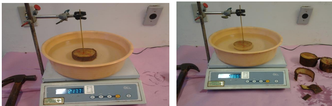
Figura 3 - Determinação do volume do disco com casca e sem casca imerso em água (volume).
