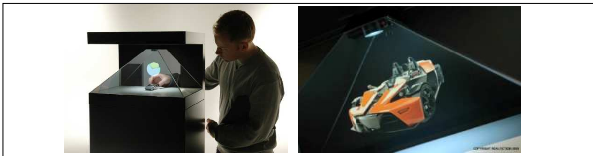
Figura 171: O Dreamoc da RealFiction : projetor holográfico.
