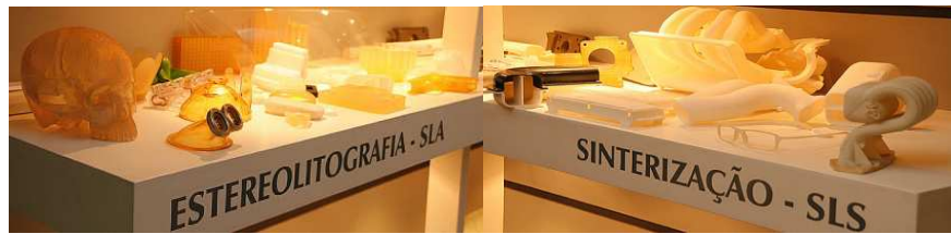
Figura 199: Exemplos de protótipos rápidos em SLA e SLS .
