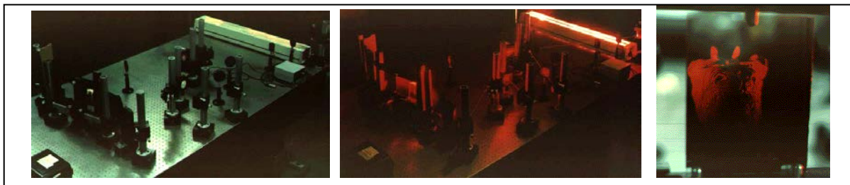
Figura 163: Mesa com laser e componentes (claro e escuro) e exemplo de holograma de transmissão.
