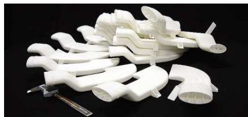
Figura 201: Exemplos de protótipos em vacuum bag .
