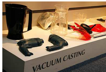
Figura 200: Exemplos de protótipos em vacuum casting
