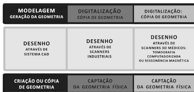
Figura 82: Técnicas de ER para a obtenção de geometrias 3D.
