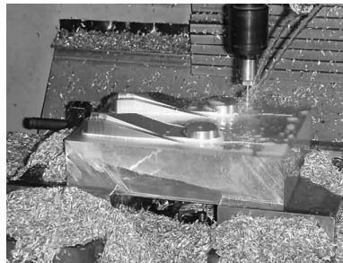
Figura 143: Exemplos de Prototipagem Rápida com SRP.
