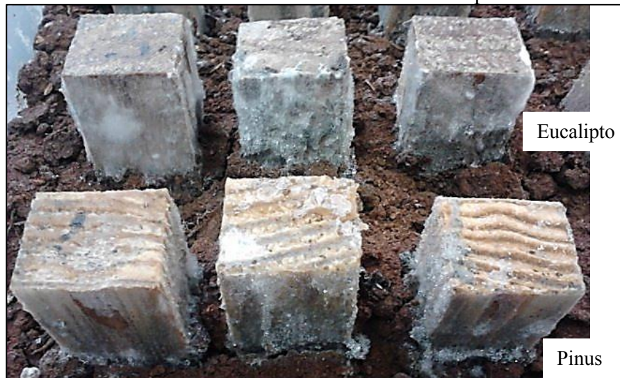
Figura 4.9 – Amostras não tratadas na 1ª semana do ensaio de apodrecimento acelerado
