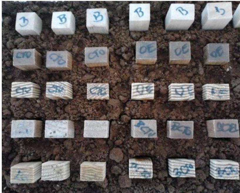
Figura 3.8 – Distribuição dos corpos de prova submetidos ao ensaio de apodrecimento acelerado
