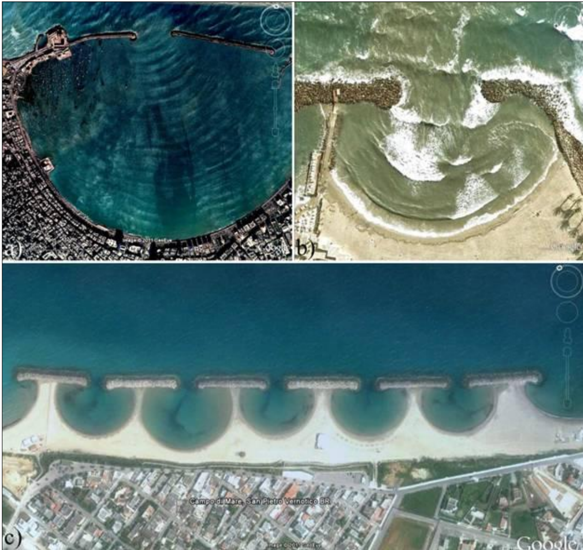
Figura 10 - Representação de processo de Difração: a) Egito, b) França e c) Itália.
