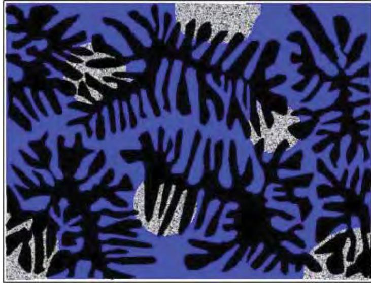
Figura 16 - Crescimento das dendritas de alumínio e nucleação do eutético Al-Si.
