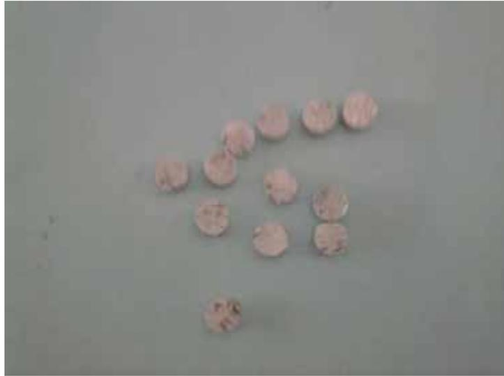
Figura 39 - Pequenos pedaços cortados pela serra de arco da anteliga Al-Sr.
