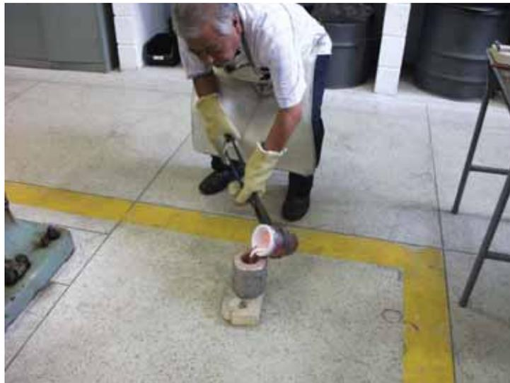
Figura 28 - Envasamento do fundido em molde de areia.
