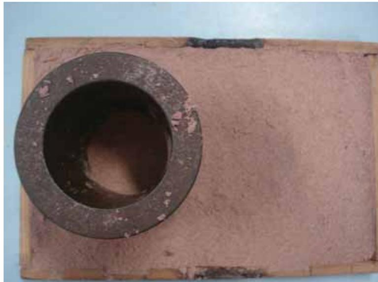
Figura 26 - Preparação do molde metálico com fundo de areia de fundição.
