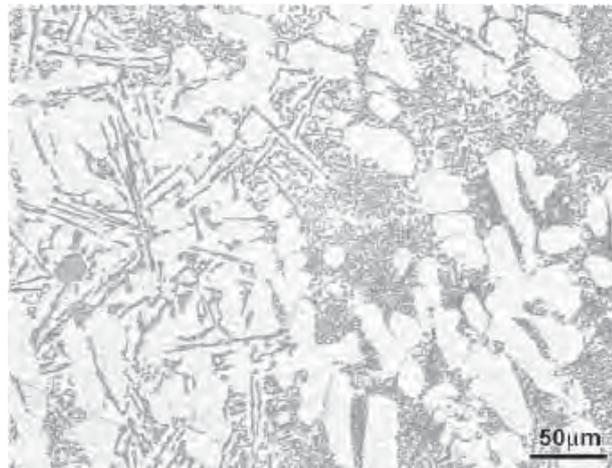
Figura 9 - Liga A356 parcialmente modificada. Partículas de silício em forma de placas à esquerda e à direita, silício refinado e com morfologia fibrosa (aumento 200x).
