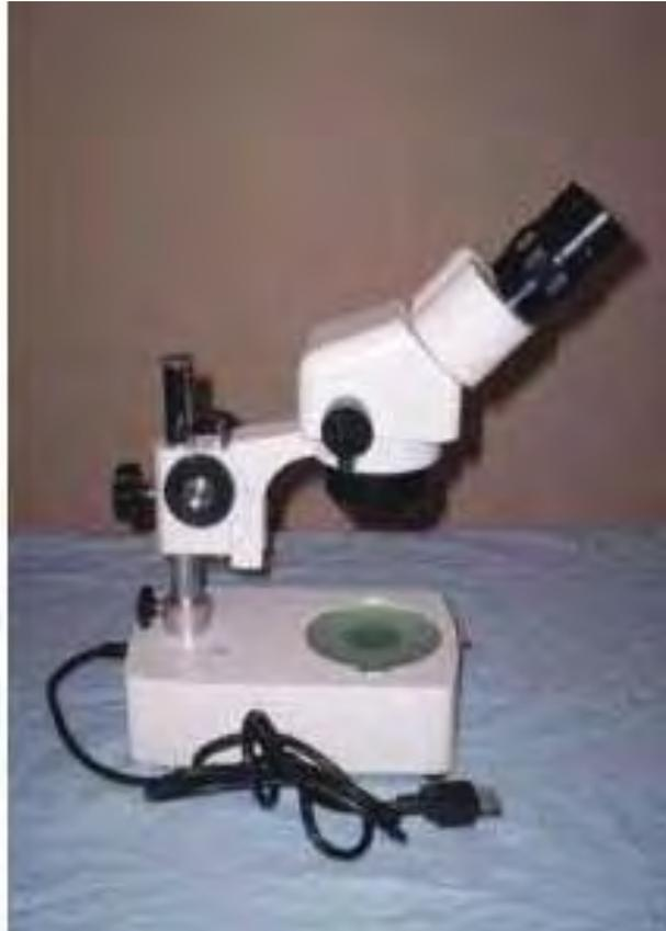
Figura 35 - Estereomicroscópio utilizado para verificação de ausência de riscos nas amostras.
