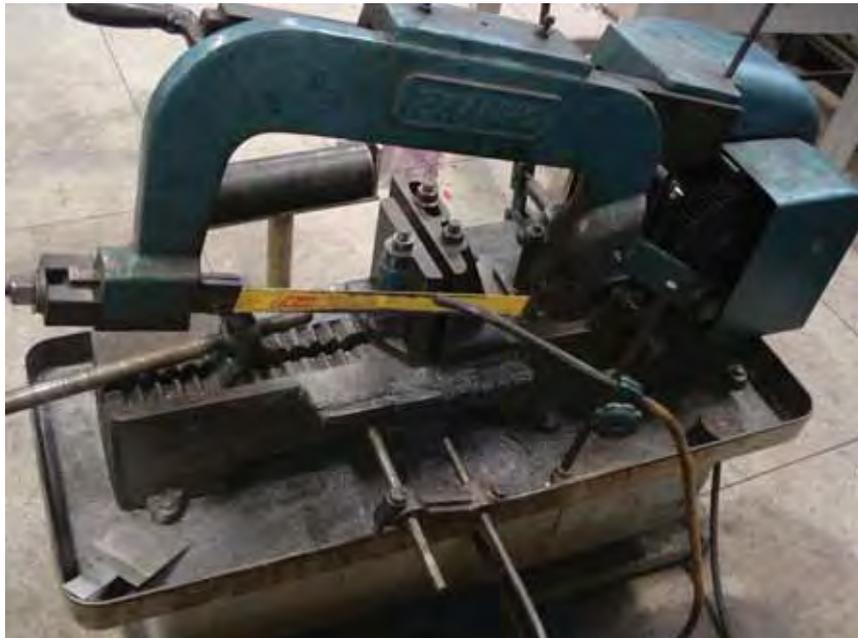
Figura 24 - Serra hidráulica, utilizada para cortar pedaços grandes da liga Al-Si AA356.
