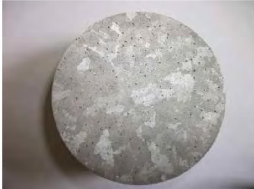
Figura 42 - Macroestrutura obtida a partir do lingote da liga de alumínio AA356 em molde de areia.
