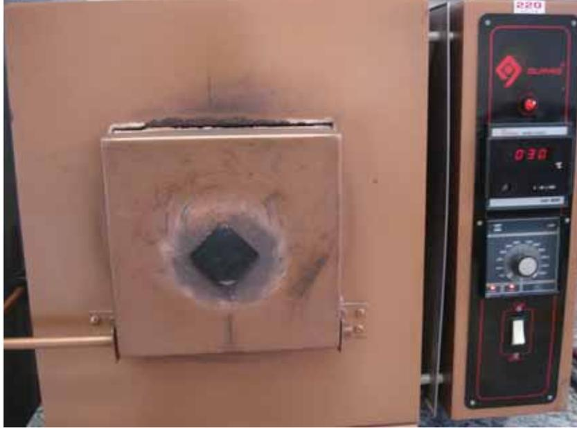
Figura 23 - Forno elétrico tipo mufla utilizado para a fundição da liga.
