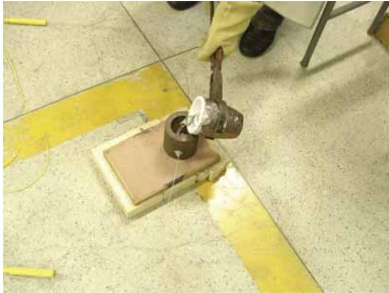
Figura 27 - Envasamento do fundido da liga no molde metálico.
