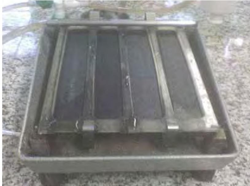
Figura 33 - Lixas de granulação utilizadas para lixar os corpos-de-prova recém embutidos.
