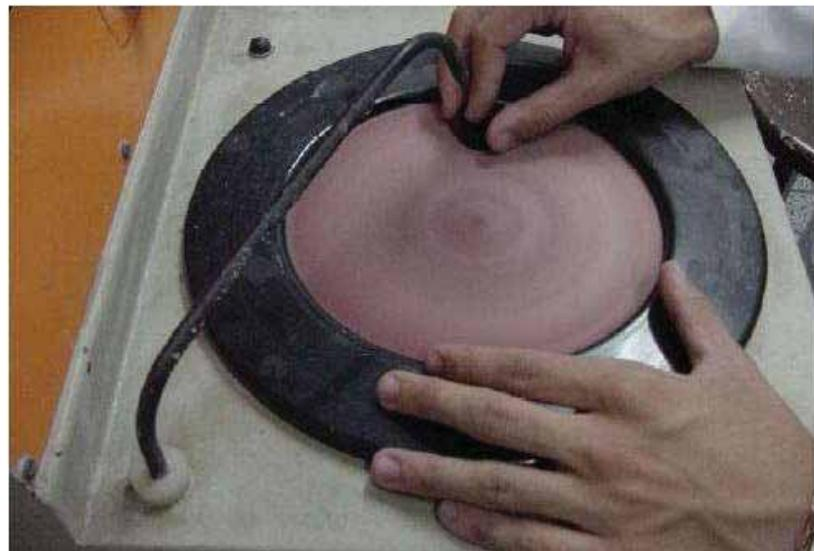
Figura 34 - Politriz automática, utilizada para o polimento das amostras.
