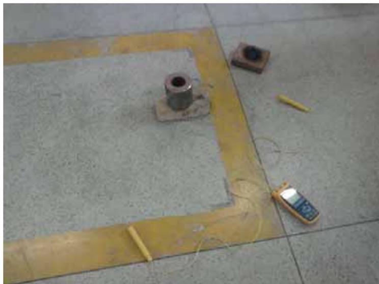
Figura 40 - Termopares conectados ao molde de areia e ao sistema de aquisição de dados.
