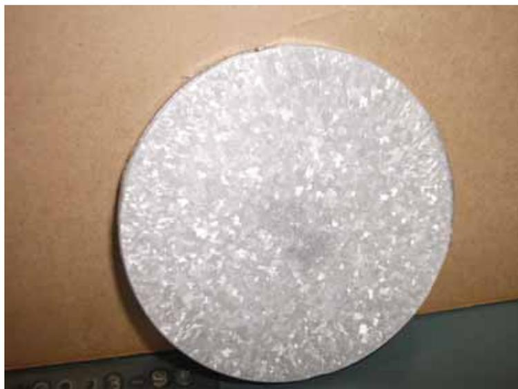
Figura 41 - Macroestrutura obtida a partir da liga de alumínio AA356 em molde metálico.
