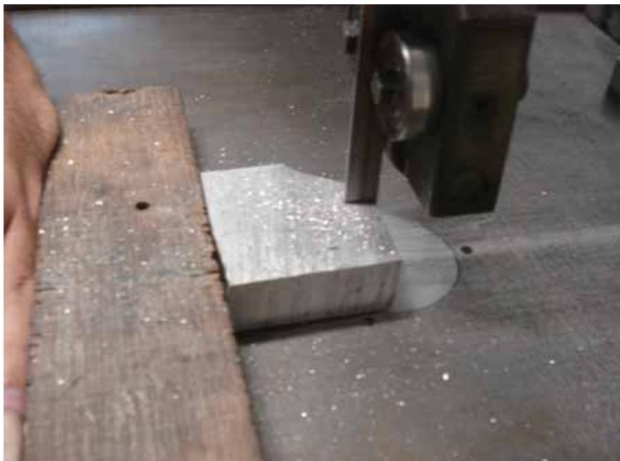
Figura 25 - Serra de fita, utilizada para cortar em pedaços menores a liga Al-Si AA356.
