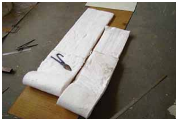
Figuras 20 e 21: Detalhe para a parte interna do gaseificador e detalhe para a lã isolante a ser inserida no corpo do gaseificador.
