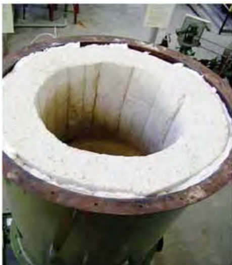
Figuras 20 e 21: Detalhe para a parte interna do gaseificador e detalhe para a lã isolante a ser inserida no corpo do gaseificador.
