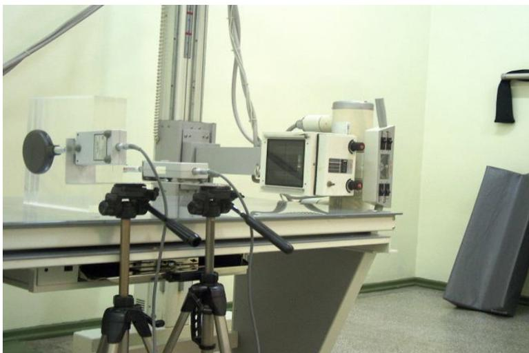
**Figura 14:** Arranjo experimental para medições de kerma no ar na entrada e saída do paciente.
