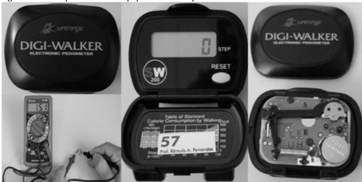
Figura 3. Verificação das baterias e peças internas dos pedômetros.
