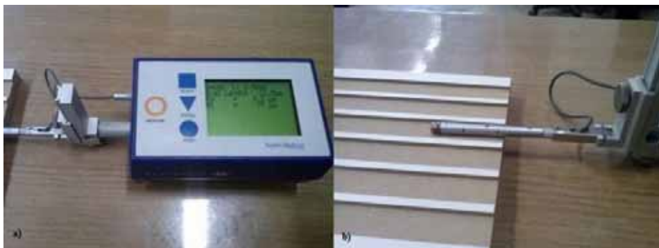
Figura 45- a) Rugosímetro Modelo SURTRONIC 25+; marca TAYLOR HOBSON. b) Haste de medição do Rugosímetro.
