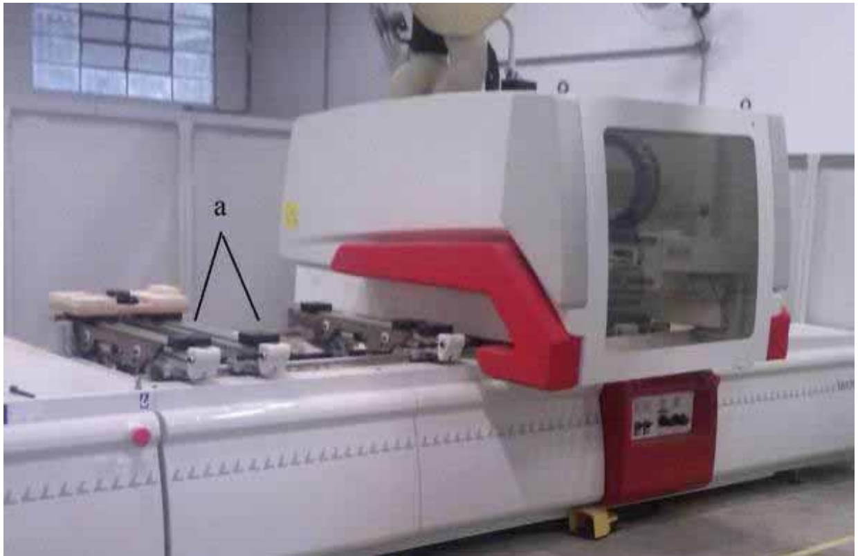
Figura 28 – Mesa base Fresadora CNC Tech Z1. 6a - dispositivos de fixação com ventosas.
