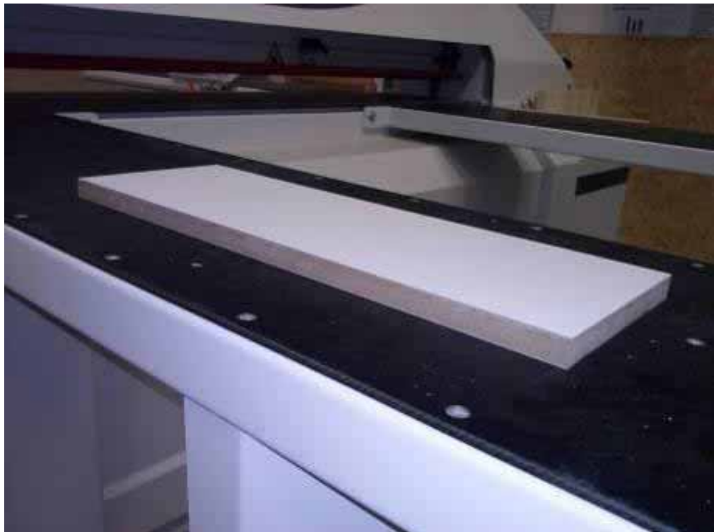
Figura 35 – Corpo de prova em MDF para fresamento frontal.
