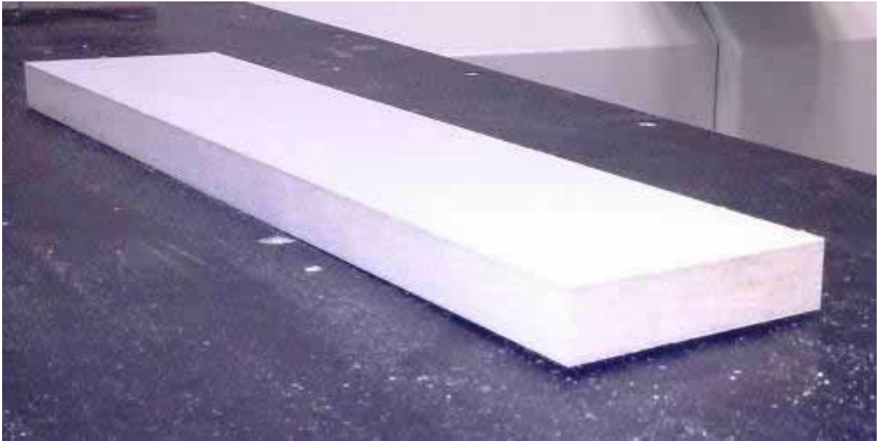
Figura 34 – Corpo de prova em MDF para fresamento tangencial.
