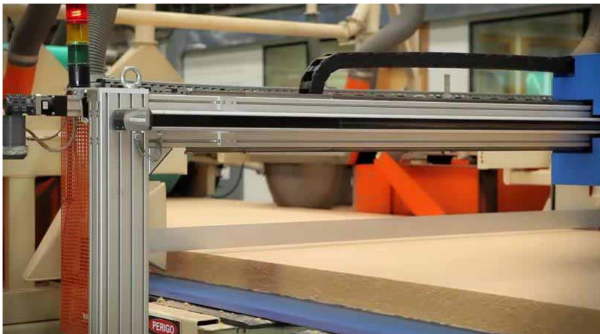
Figura 4 - MDF na pré prensa para homogeneizar a densidade.
