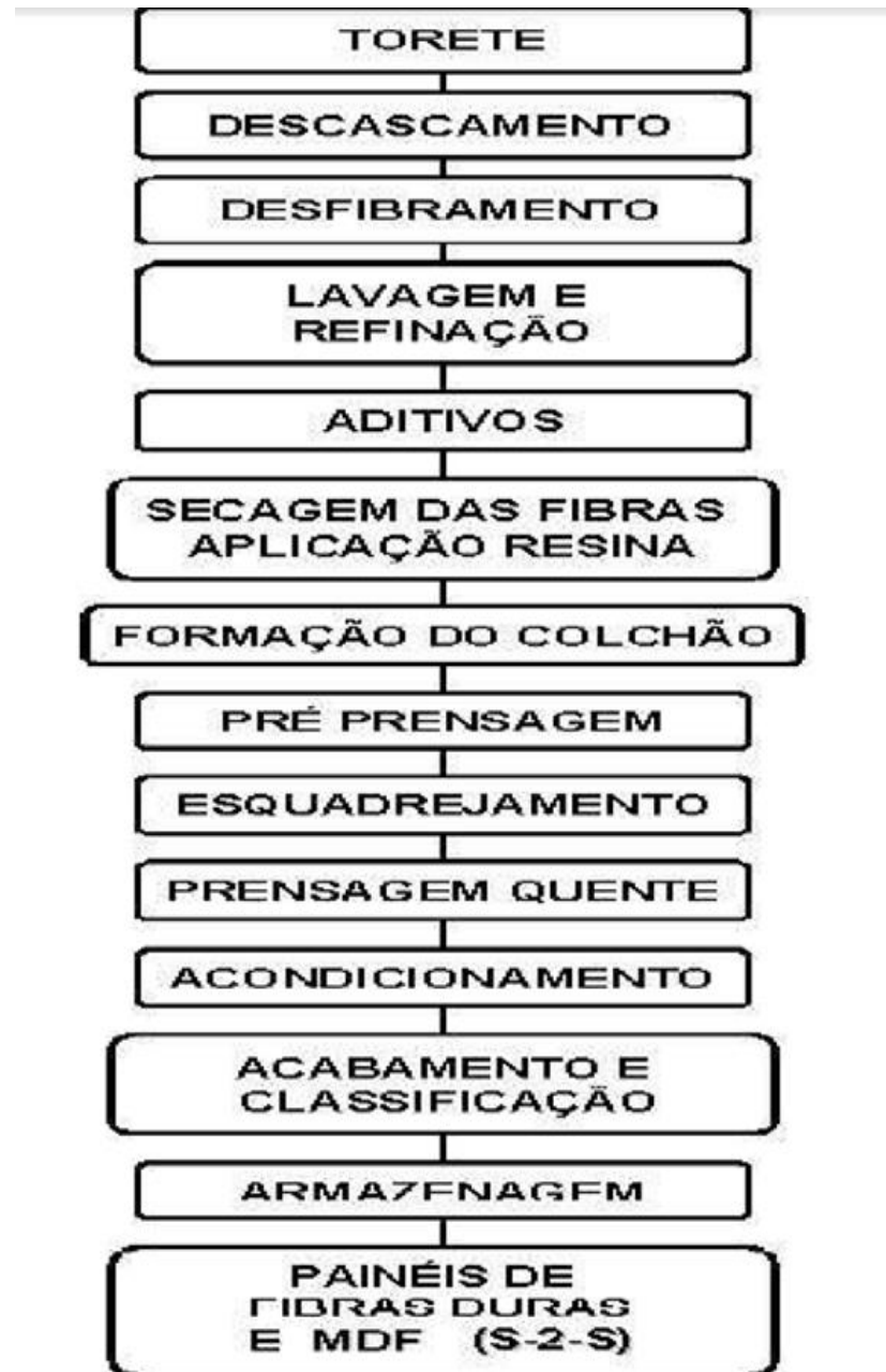
Figura 3 - Processo seco para obtenção de painéis MDF.
