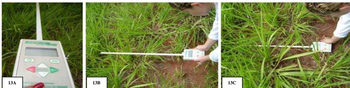
FIGURA 13. Avaliações de interceptação luminosa (IL). 13A – Equipamento utilizado no monitoramento da IL pelo dossel. 13B – Avaliação da incidência de radiação acima das plantas. 13C – Avaliação da interceptação de radiação pelas plantas.
