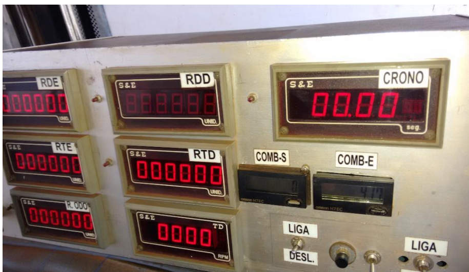
Figura 4. Sistema eletrônico de aquisição de dados instalado na cabine do trator.
