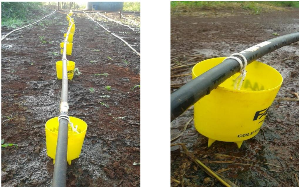
Figura 5. (A) Ensaio de vazão nos tubos gotejadores e (B) detalhe do coletor.
