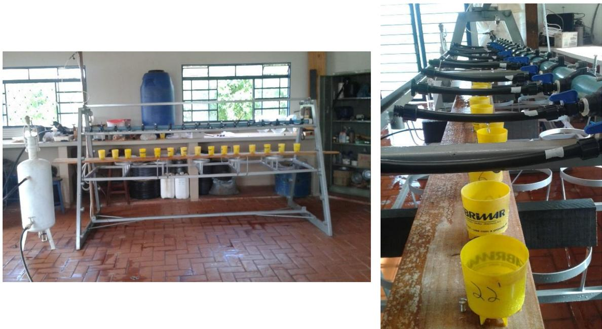
Figura 2. (A) Bancada de ensaio de vazão dos tubos gotejadores e (B) coletores no sistema em operação.
