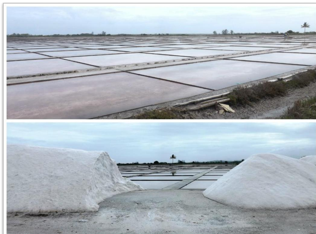
Figura 37: Tanques de deposição das águas da Lagoa Vermelha e os montes de sal extraído.
