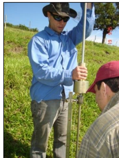
Figura 10. Registro da resistência mecânica do solo. Fonte: Edvania Ap. Corrêa.
