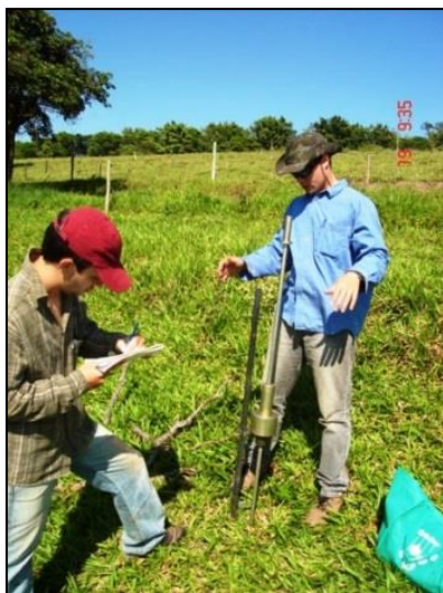
Figura 9. Uso do penetrômetro de impacto. Fonte: Edvania Ap. Corrêa.
