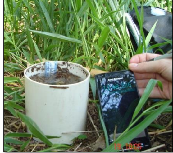
Figura 8. Registro da alteração do nível da água no infiltrômetro. Fonte: o autor.
