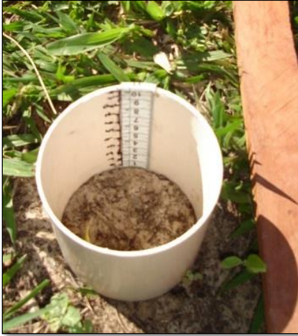
Figura 7. Fixação do infiltrômetro. Fonte: o autor.
