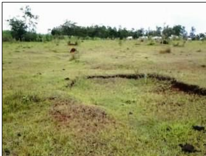
Figura 44. Feições de abatimento de superfície no setor próximo às parcelas experimentais JP1 e JP2.
