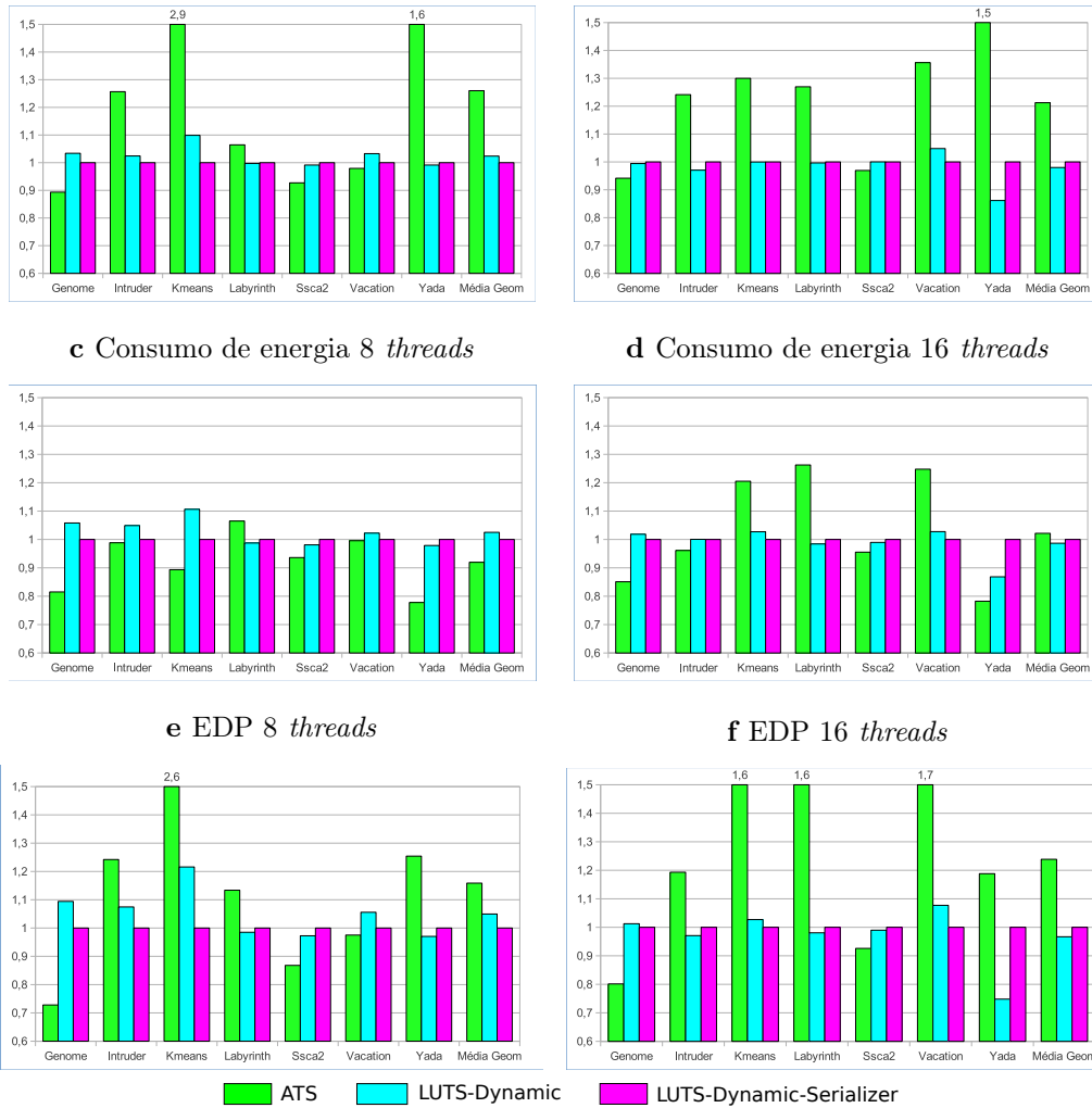
Figura 4.8: Gráficos normalizados com LUTS-Dynamic-Serializer a Tempo de execução 8 threads b Tempo de execução 16 threads
