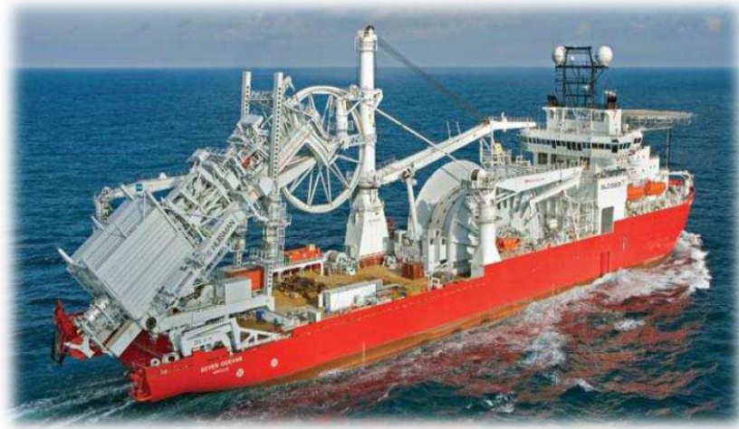
Figura 2: Navio especializado no lançamento de dutos pelo método carretel.
