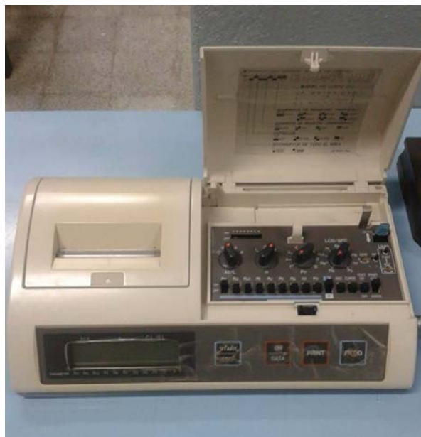
Figura 11: Rugosímetro portátil modelo Surftest 301.
