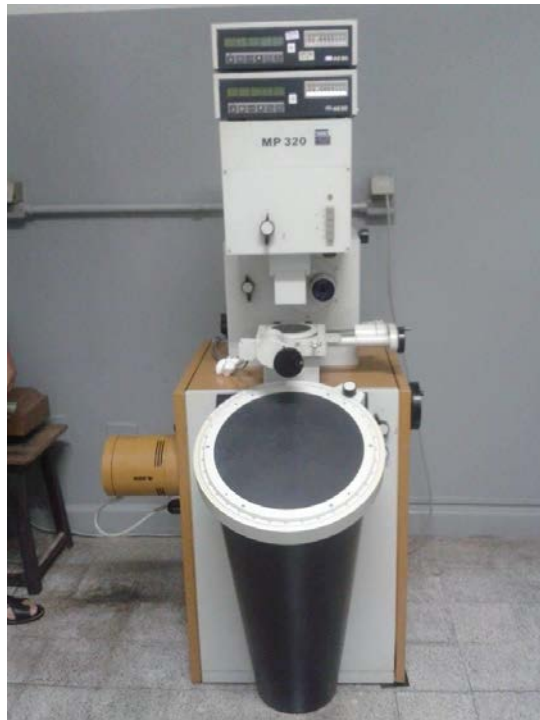
Figura 14: Projetor de perfil, modelo MP 320, com resolução para medição linear de um milésimo de mm.
