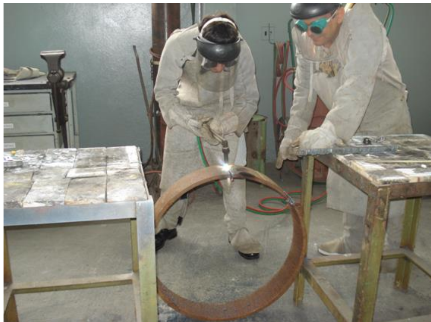
Figura 10: Anel do tubo de aço API X70, sendo cortado através do processo de oxicorte
