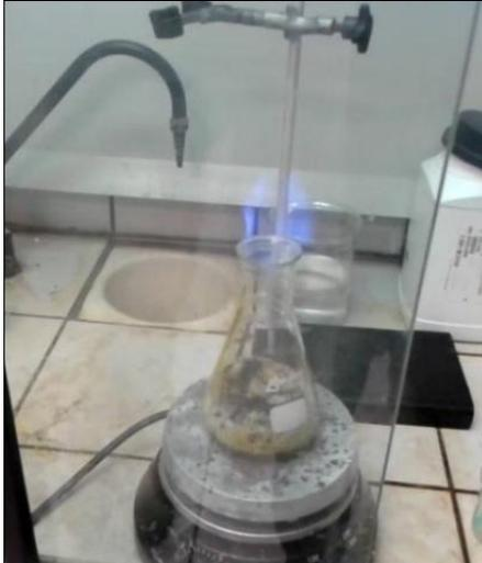
Figura 1. Chama produzida pela queima de H<sub>2</sub> resultante da reação do Al metálico com HCl na presença de Cu<sup>2+</sup>.
