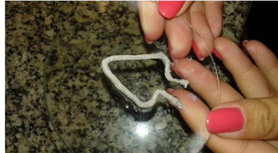
Figura 2. Deposição espontânea de Ag metálica sobre um fio de cobre.
