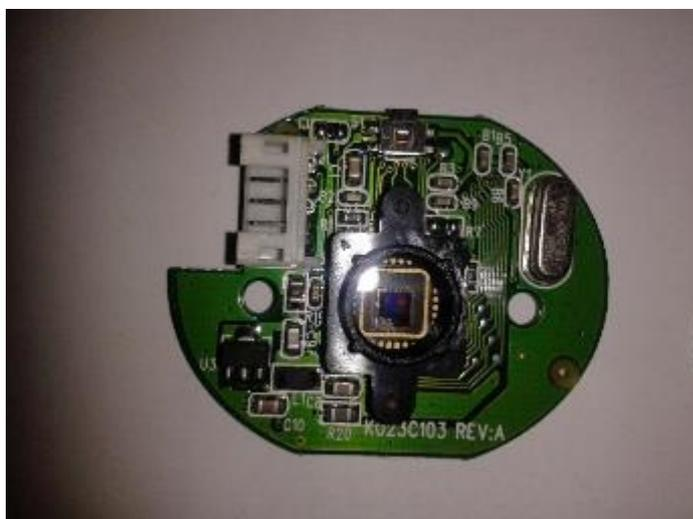
O sistema de detecção é composto por uma lente convexa, um filtro de Bayer e o sensor CMOS montado sobre uma eletrônica simples de aquisição, amplificação e transformação da luz registrada pelo sensor para um sinal digital.
