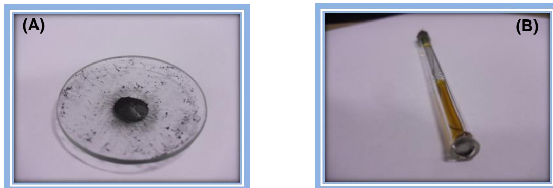
Figura 9. Construção do eletrodo de pasta de carbono. (A) Pasta de carbono modificada. (B) Eletrodo de trabalho adequado para montagem do sensor.
